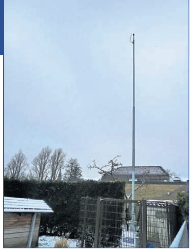
Het officiële NOMOS meetpunt voor vliegtuigeluid bij de Meldijk in Uitgeest. Overal waar intensief gevlogen wordt rondom Schiphol vind je dergelijke meetpunten, die met elkaar een beeld geven van de totale geluidsbelasting. Na de Alders-experimenten dreigen bij de besluitvorming in 2013 deze eens zo enthousiast geplaatste meetpunten ter bescherming van de burgers te verdwijnen.
