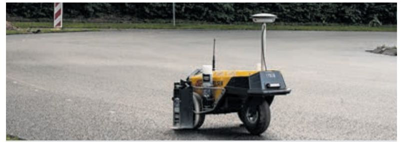
De Robot Plotter in actie. Foto: Bart Lendfers
