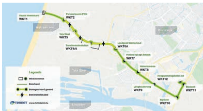
Het bijna tien kilometer lange ondergronds geboorde tracé van strand Heemskerk tot het hoogspanningsstation langs de A9. Afbeelding: TenneT
