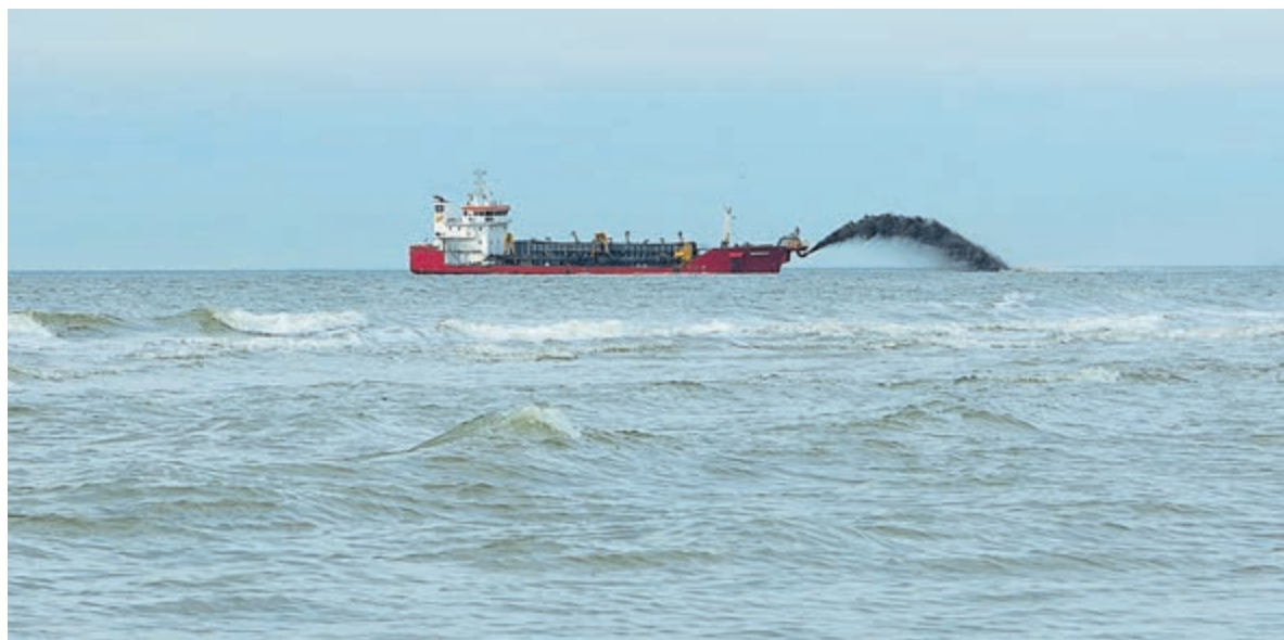
De sleepopperzuiger van Boskalis spuit het zand richting de kust. Foto: Henk de Reus
