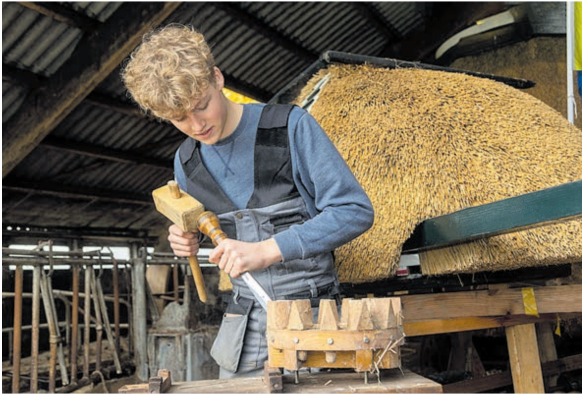
Stan, bezig met de laatste handelingen aan het kleine tandwiel van de molen. Foto: Henk de Reus
