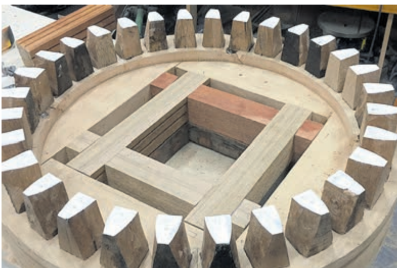
Het grote houten tandwiel (doorsnede van 65 centimeter) heeft Stan helemaal met de hand gemaakt. Foto: Stan Baltus
