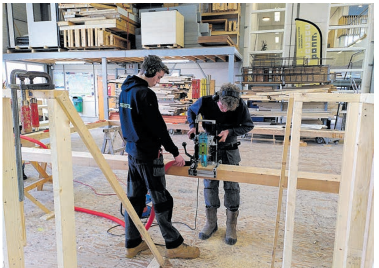
Stan (r) maakt op het Regiocollege de houtverbindingen van de onderbouw van de molen. Foto: Henk de Reus
